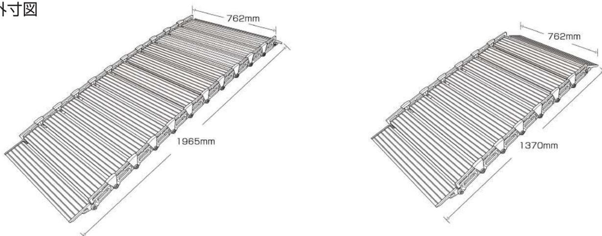
※プレートを取りはずして長さを短く調整することも可能です。プレートをはずす際は付属の工具を使用ください
